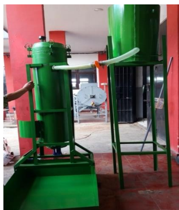
Gambar 1. Konstruksi Alat Penjernih Udara Hasil Rancang Bangun
