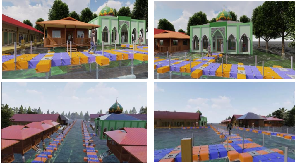
Gambar 6. Arahan Desain Rekonstruksi Prasarana Jalan dengan Sistem Floating Dock di Kelurahan Salomenraleng
