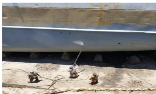
**Gambar 2.** Pekerja yang tidak menggunakan Helm saat pengecatan kapal
