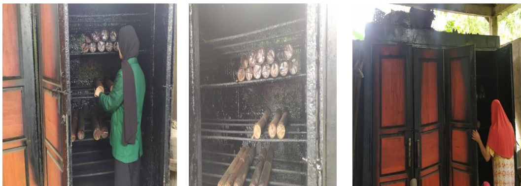
Gambar 6. Proses penyusunan dan pembakaran tembakau dalam bentuk bambu ke lemari pembakaran
