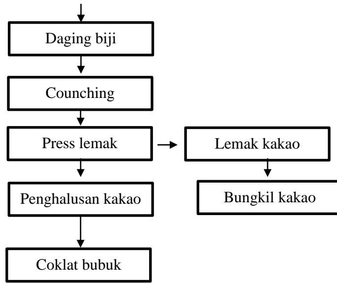
Gambar 3. Flowchart Proses Pengolahan Biji Kakao Menjadi Coklat Bubuk Pada Usaha Coklat X.
