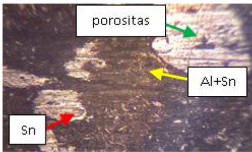
Gambar 5. Struktur Mikro Bahan Paduan Serbuk Aluminium-timah (Al 60% - Sn 40%)
