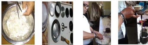
**Gambar 2.** Proses Pencacahan Bulu, media cetakan, dan proses pembuatan panel
