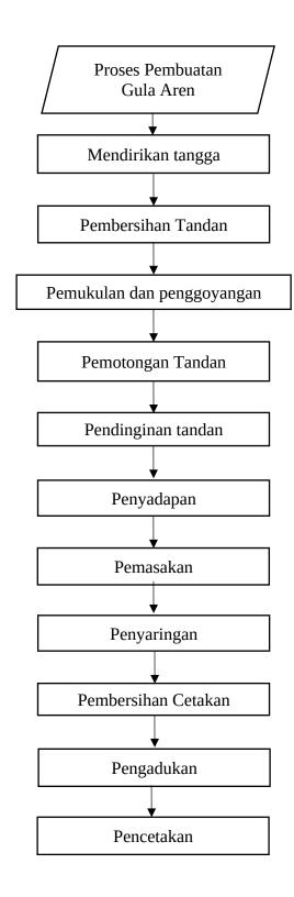
Gambar 3. Proses Pembuatan Gula Aren
